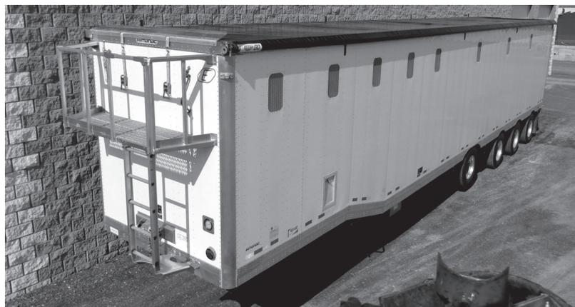
Dispositif d'opération muni d'une manivelle couplé par un joint universel au tube d'enroulement. Recommandé pour la manutention d'une toile de petite à moyenne envergure. Comme tous les systèmes ELCargo, des tendeurs à ressorts sont installés au tube d'enroulement pour faciliter l'utilisation.
